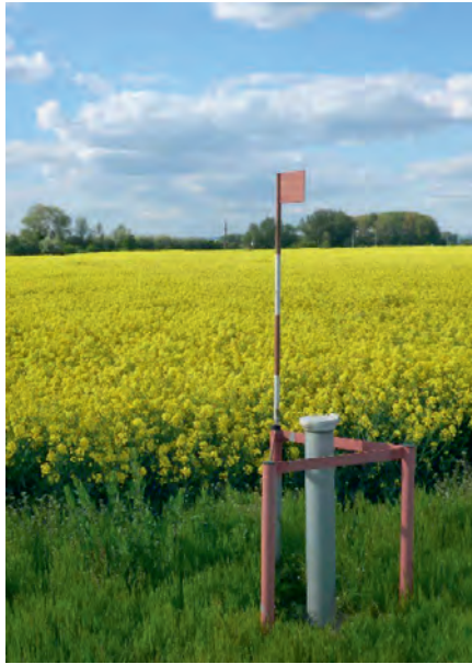
Abbildung 19: Grundwassermessstelle Stotternheim (Quelle: ThLG)
