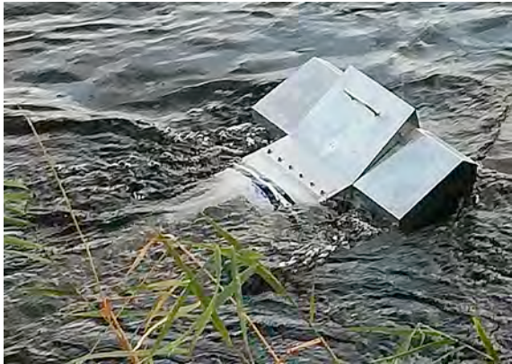
Abbildung 83: „Mantaroche“ – Werkzeug zur Probenahme von Mikroplastik (Quelle: TLUBN)
