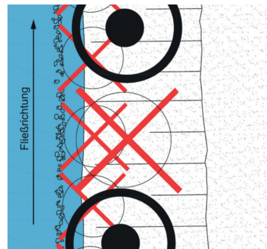
Abbildung 44: Die Gehölzabstände untereinander sind durch Auslichtungen zu regulieren. (INGBIOTOOLS, 2017)
