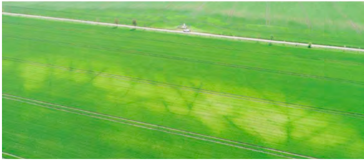
Abbildung 9: Luftbild zur Lokalisierung von landwirtschaftlichen Entwässerungsanlagen (Quelle: Apus Systems – Fabian Neumann)
